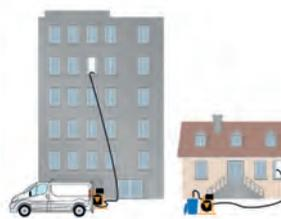
Grâce à son enrouleur hydraulique vous pouvez réaliser un enroulage et un déroulage assisté en toute sécurité sans effort jusqu'à 80 mètres en enduit (soit environ 9 étages) en conservant une bonne amplitude de travail et jusqu'à 120 mètres en peintures.
